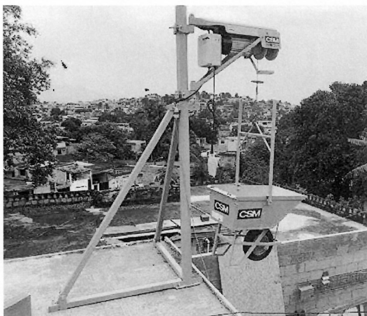
Figura 4. Foto ilustrativa do guincho de coluna
