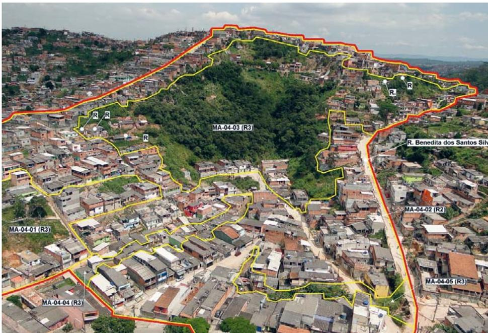
Imagem 7.7 - Exemplo de mapeamento de área de risco de deslizamento, o qual auxilia nos trabalhos de prevenção.
