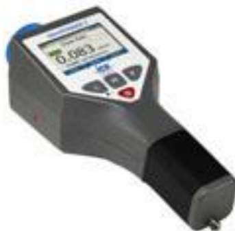
Figura 6.20 - Espectrômetro gama, com NaI(Tl)+GM e analisador multicanal, portátil, que permite determinar a energia da radiação, obter o espectro e identificar o radionuclídeo.
