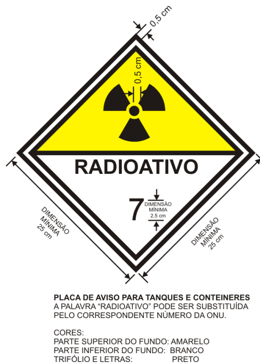
Figura 9.2 - Placa para tanques e contêineres. A palavra RADIOATIVO pode ser substituída pelo número de classificação de materiais da ONU, conforme tabela 9.5.
