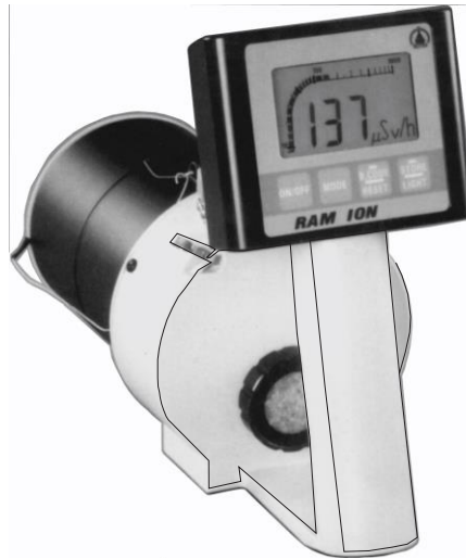
Figura 6.7 - Câmara de ionização, portátil, tipo babyline , com faixa de medição de 0,1 \text{ mR.h}^{-1} a 50 \text{ R.h}^{-1} ( 1 \mu\text{Sv.h}^{-1} a 500 \text{ mSv.h}^{-1} ), para detecção de radiações X, gama e beta em instalações nucleares, clínicas de medicina nuclear, radiodiagnóstico e radioterapia.
