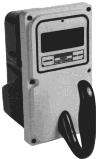
Figura 6.8 - Câmara de ionização pressurizada, portátil, para medição de níveis baixos de radiação X e gama, provenientes da radiação de fundo, fugas de aparelhos usados em radiodiagnóstico e radioterapia e radiação espalhada.
