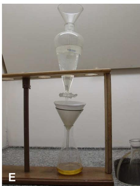
FIGURA 14: Processo de recuperação de bromofórmio misturado com álcool remanescente de separação densimétrica. A: kitasato conectado a torneira, com mistura álcool + bromofórmio a ser separada; B: líquido branco produzido durante o início do fluxo de água, devido à mistura água + álcool; C: bromofórmio (líquido amarelo no fundo) mais água; D: balão de separação utilizado para recolher o bromofórmio no frasco Erlenmeyer; E: separação final do bromofórmio recuperado no frasco Erlenmeyer.
