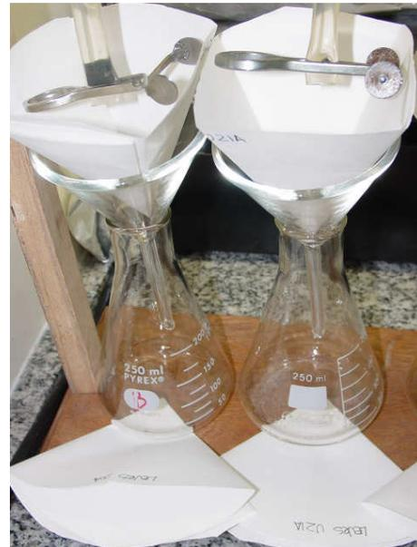
D - Detalhe da pinça de Mohr que controla a saída de bromofórmio + grãos de minerais pesados do funil superior, e do frasco Erlenmeyer destinado a coletar o bromofórmio filtrado. Notar minerais pesados concentrados no tubo de saída do funil superior.
